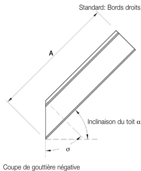
Coupe de gouttière négative  $\sigma =$  inclinaison du toit  $\alpha$
